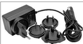
Universalnetzteil 24 VDC/1 A. Eingang 100÷240 VAC. Kabellänge 3 m.
